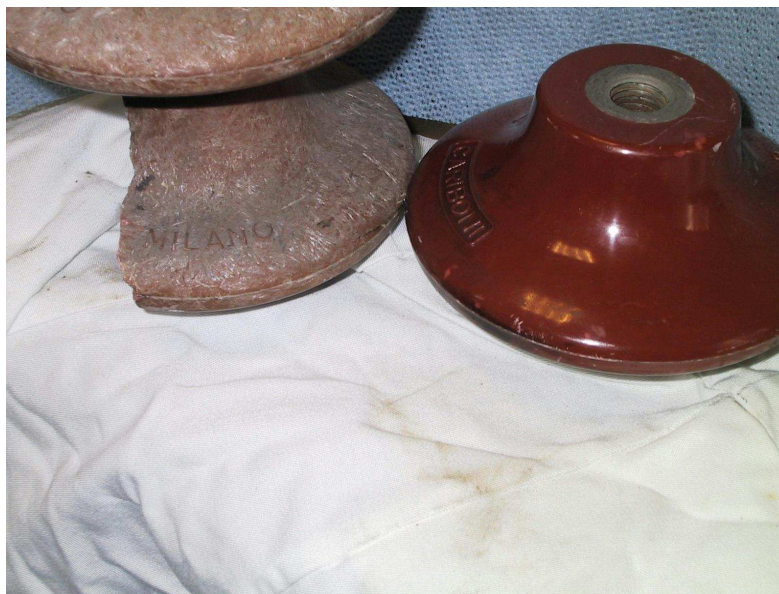
Figura 5 - Isolatore portante 145 kV, dopo 5000 ore di ciclo d'invecchiamento CESI-ENEL, simulante oltre 7-10 anni di invecchiamento all'esterno, confrontato con il campione Tal Quale rappresentabile con prodotto siliconico rosso CSL-Silicones: vernice al silicone, formulato su richiesta di cui i grafici di Fig.4 sopra riportati.
