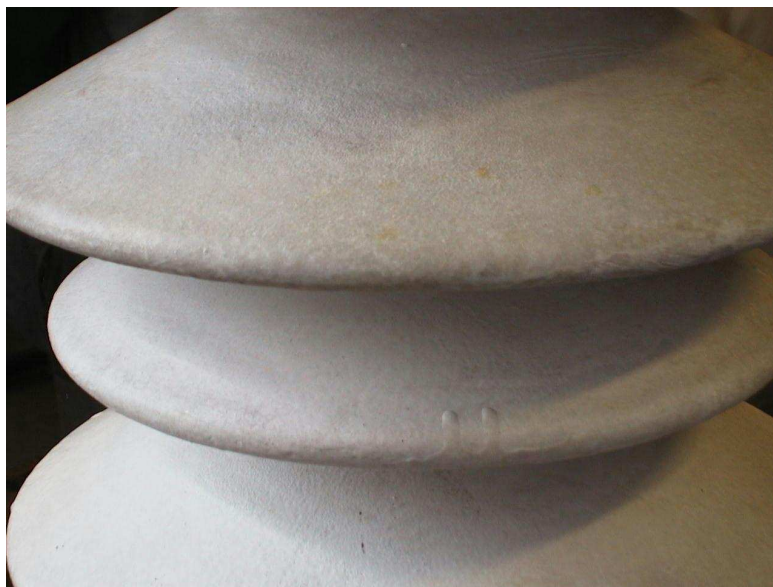
Figura 6- Isolatore portante 145 kV, in ceramica rivestito con gomme siliconiche. Aspetto dopo 5000 ore di ciclo d'invecchiamento CESI-ENEL, simulante oltre 7-10 anni di invecchiamento all'esterno, colore Bianco Dow Corning; vernice al silicone.
